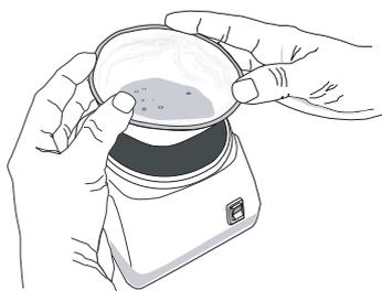
Vibre a mistura ainda dentro da tigela por 40 segundos, eliminando as bolhas de ar aprisionadas.
