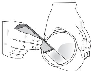
Misture *Plastique* usando a proporção de água - pó de 20ml - 100g, manualmente por 45 segundos.
