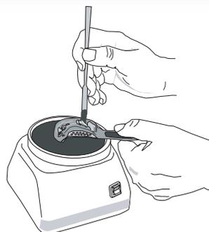
Verta sob vibração, lentamente, pequenas porções da mistura nas cavidades de sua moldagem, tendo o cuidado de deixá-las fluir lentamente, pelas laterais da moldagem.
